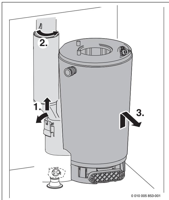
Рис. 82 Демонтаж теплообменника
