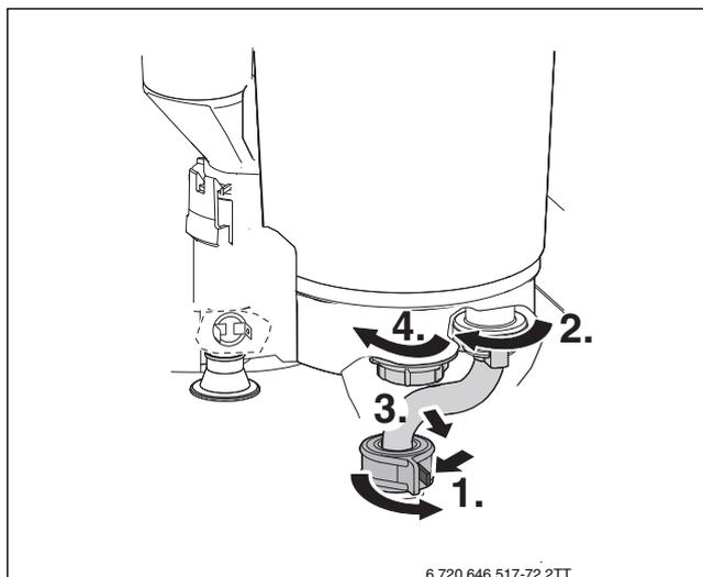
Рис. 81 Отверните гайку и отсоедините трубу обратной линии
