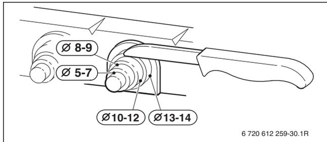
Рис. 32 Обрежьте фиксатор в соответствии с диаметром провода
