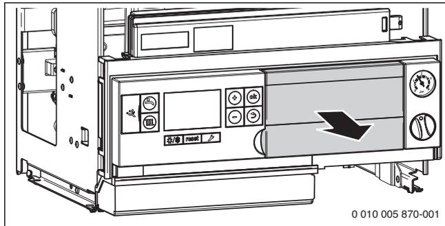
Рис. 30 Удаление крышки и установка пульта управления
