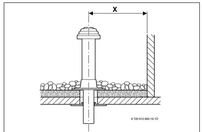
Рис. 5 Расстояния для плоской крыши
