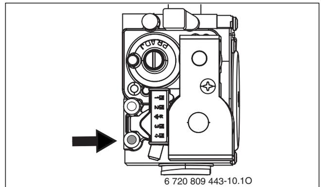
Рис. 52 Штуцер для измерения подаваемого давления газа
