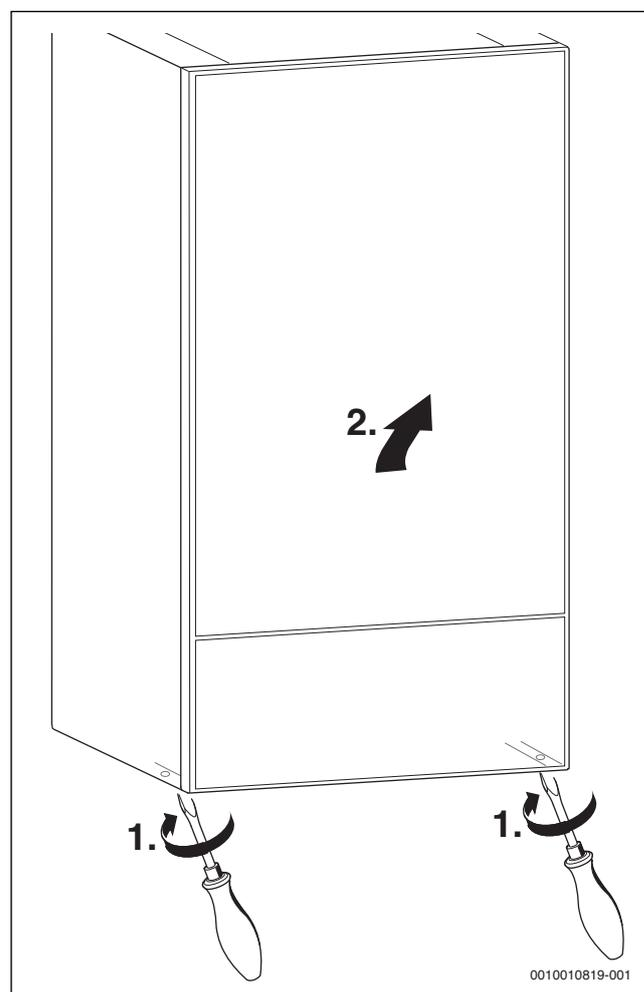
Рис. 23 Снятие облицовки
