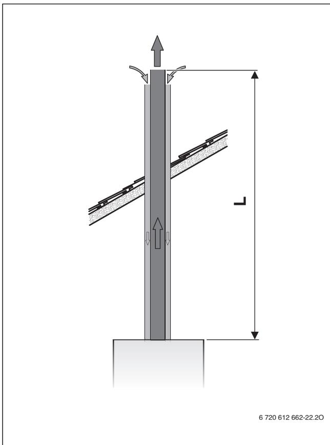
Рис. 14 Вертикальный отвод дымовых газов по C<sub>33</sub>
