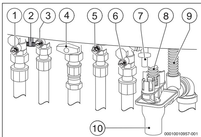
Рис. 28 Подключения газа и воды (дополнительная комплектация)
