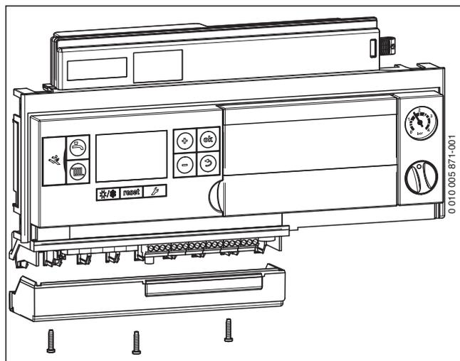
Рис. 76 Снимите крышку
