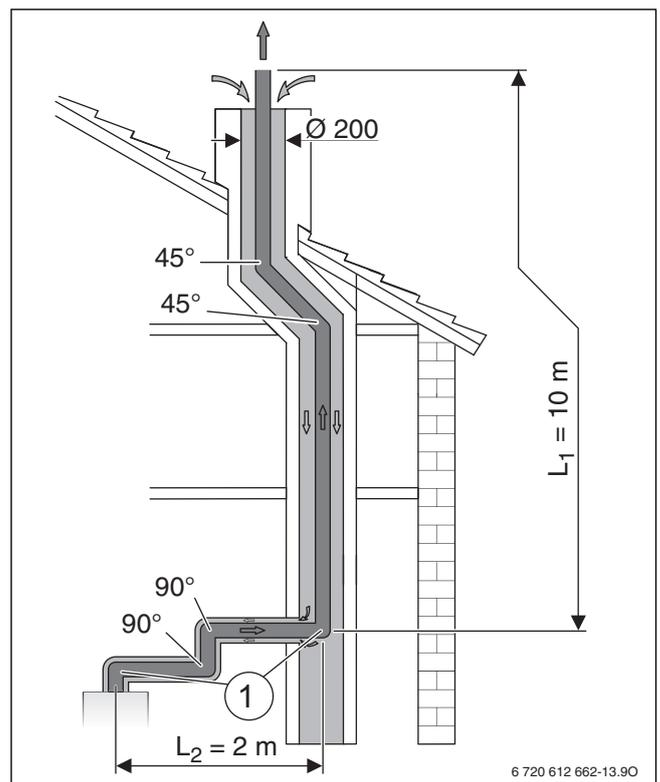
Рис. 17 Монтажная ситуация с отводом дымовых газов по C<sub>93</sub>
