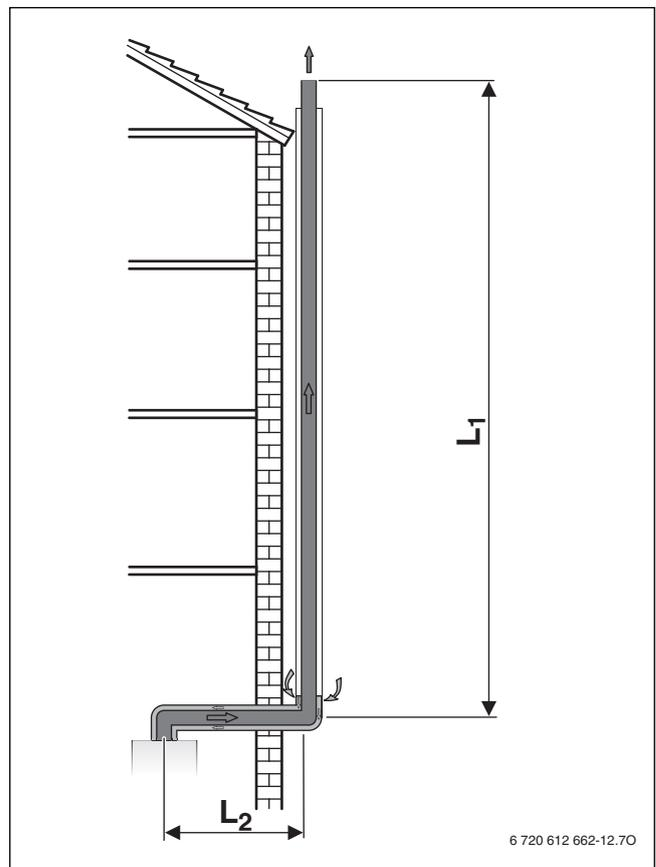
Рис. 16 Дымовая труба на фасаде по C<sub>53</sub>
