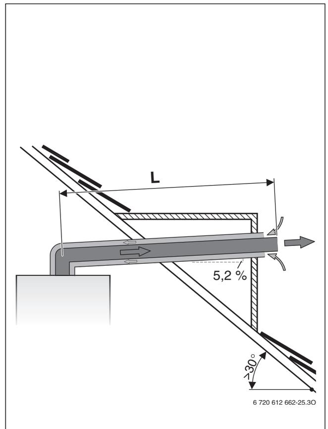
Рис. 12 Горизонтальный отвод дымовых газов по C<sub>13</sub>
