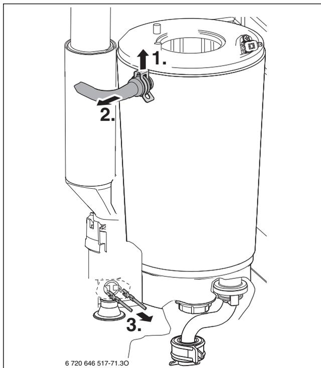
Рис. 80 Отсоедините трубу подающей линии и провода
