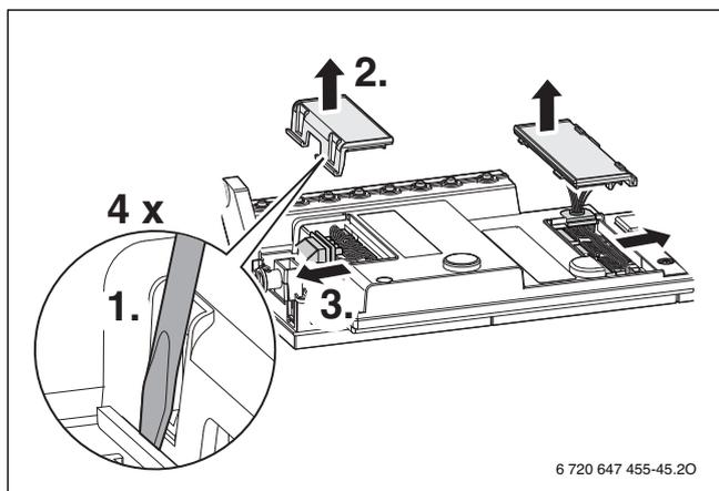
Рис. 78 Снимите крышку
